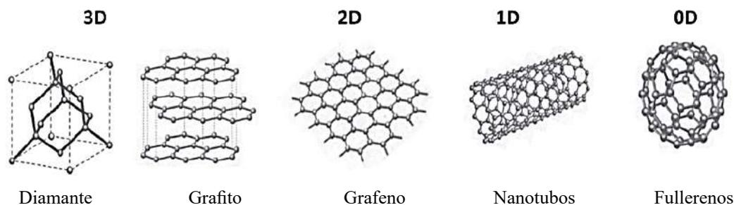
Figura 1.3 Estructuras químicas de las formas alotrópicas del carbono.
