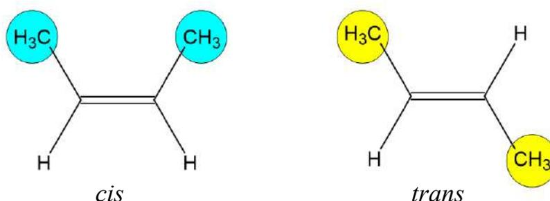
Figura 2.6 Ejemplos de alquenos con isomería cis y trans: cis-2-buteno y trans-2-buteno.
